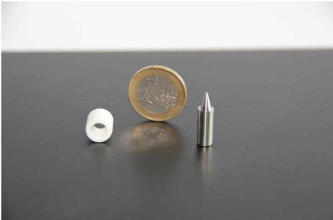
Abbildung 3.41.: Foto der Keramikpasshülse und einer Endkappe.
