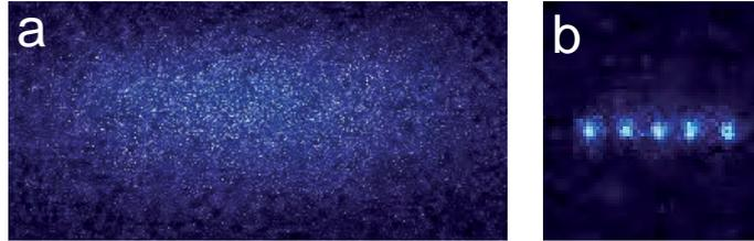
Abb. 4.5: Heiße Ionenwolke (a) und kalter Ionenkristall (b), hier bestehend aus fünf Ionen, gegenüber (a) zweifach vergrößert abgebildet. Der Ionenabstand beträgt ca.  $10 \mu\text{m}$ .
