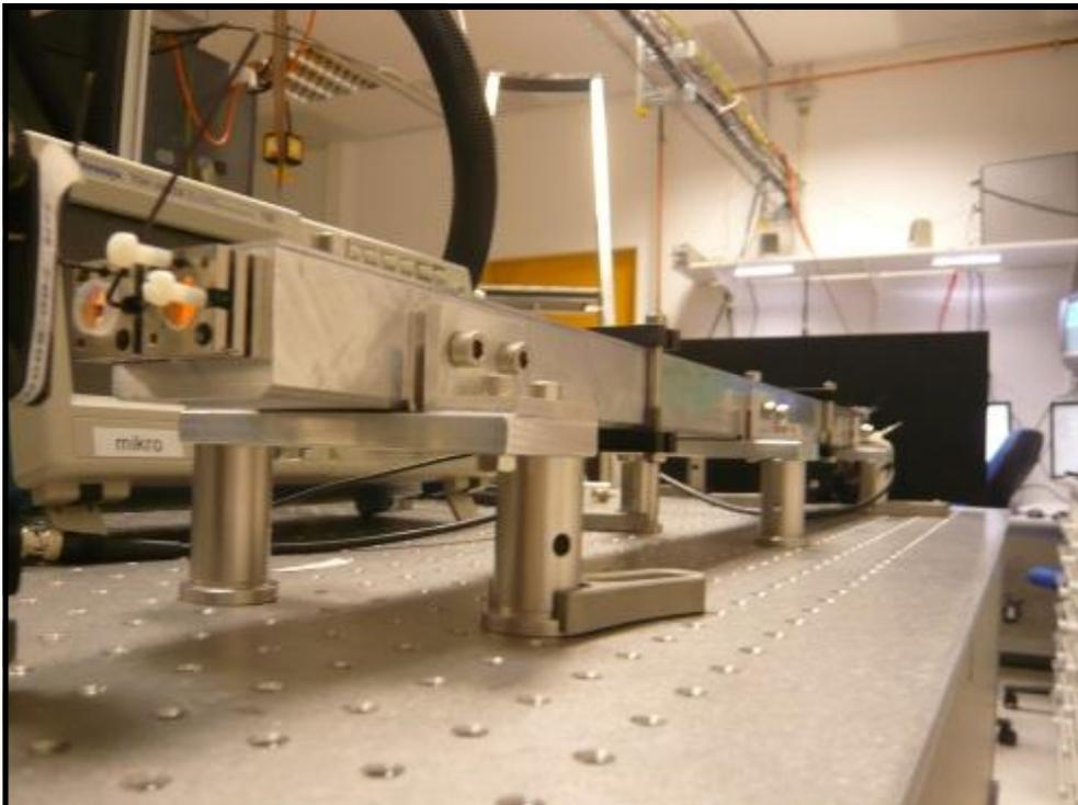
**Abbildung 8.4:** Fotografie des Filterresonators.
